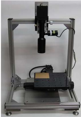
CCDカラーカメラを用いて、色彩値／表面粗さ／鏡面性／膜厚等を測定する検査装置です。二次元のRGB信号を反射率に変換し、測定面内の反射頻度値分布を、独自のアルゴリズムで解析し、表面性状に関する多数の指数を測定します。
