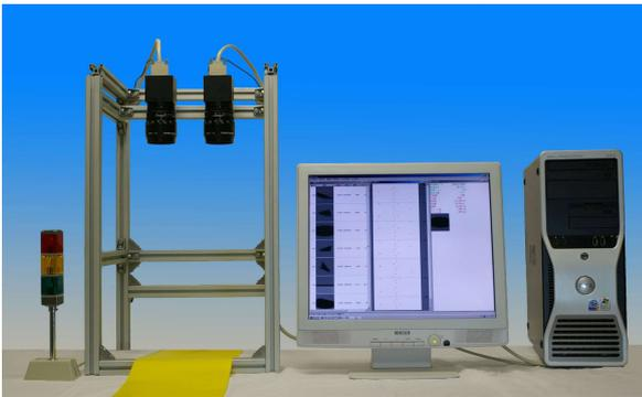
GK-2000 外観検査装置は、ラインカメラによるオンライン用外観検査装置です。リアルタイムに製品の外観を検査、欠陥を検知すると外部機器へ信号出力し、欠陥画像および情報を保存します。欠陥画像の保存により、視覚的に欠陥の状況を確認することができます。
