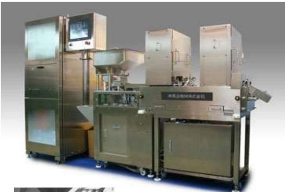
錠剤の目視検査機に自動検査装置と排除装置をセットした錠剤検査装置。
