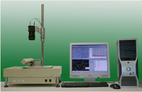
画像処理装置 PRO-7は、ラインカメラから入力したデータを二次元画像表示し、各種画像処理を行う装置です。一般のカメラの分解能では満足できない、高精細な画像計測や円筒形状の製品の展開図の入力等に適しています。
